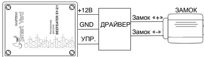
Рисунок 1 — Схема подключения драйвера
